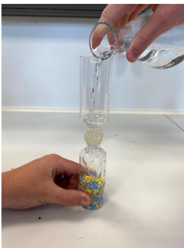
Abbildung 40: Auffüllen mit der Wasser/Glycerin-Mischung
