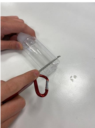
Abbildung 26: Absägen des Bodens einer Flasche
