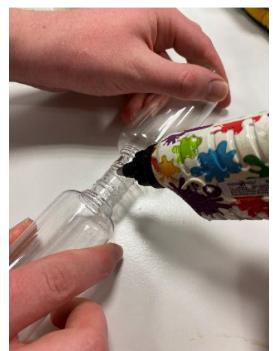
Abbildung 28: Zusammenkleben mit Heißklebe
